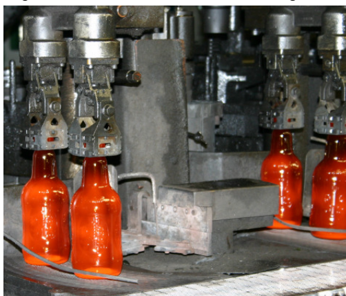
Glasmaschine mit glühend heißen neu geformten Glasflaschen
